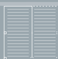
FRONT LEANING VERSION COUPLED MODULE 2 POSTS (BLADES PARALLEL TO THE WALL) / AN DIE WAND GELEHNTE VORDERE VERSION GEKÜPPELTE ANLAGEN 2 BEIN (ZUR WAND PARALLELE LAMELLEN)
