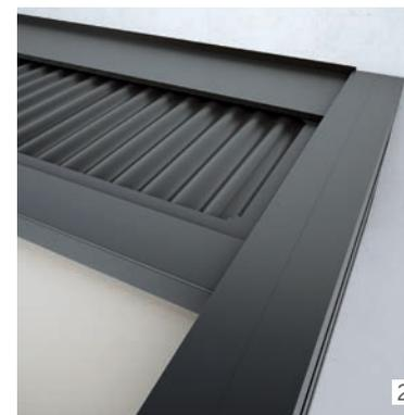
**1. EN fly cloth/guttering** A spring elastic system stretches the cloth for the best wind resistance. The lower part of the frame acts as rainwater guttering. **DE Tuch Fly/Regenrinne** Ein elastisches System mit Federn spannt das Tuch für optimalen Windwiderstand. Das Unterteil vom Rahmen wird als Regenrinne zum Ableiten vom Regenwasser genutzt.
